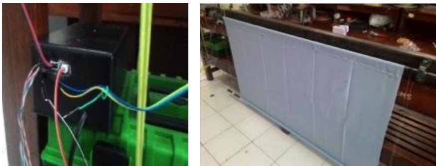
Gb 8. Piranti ekperimental tirai buka tutup otomatis
