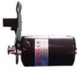
Gb. 5. Motor universal satu fasa aktuator tabir otomatis
